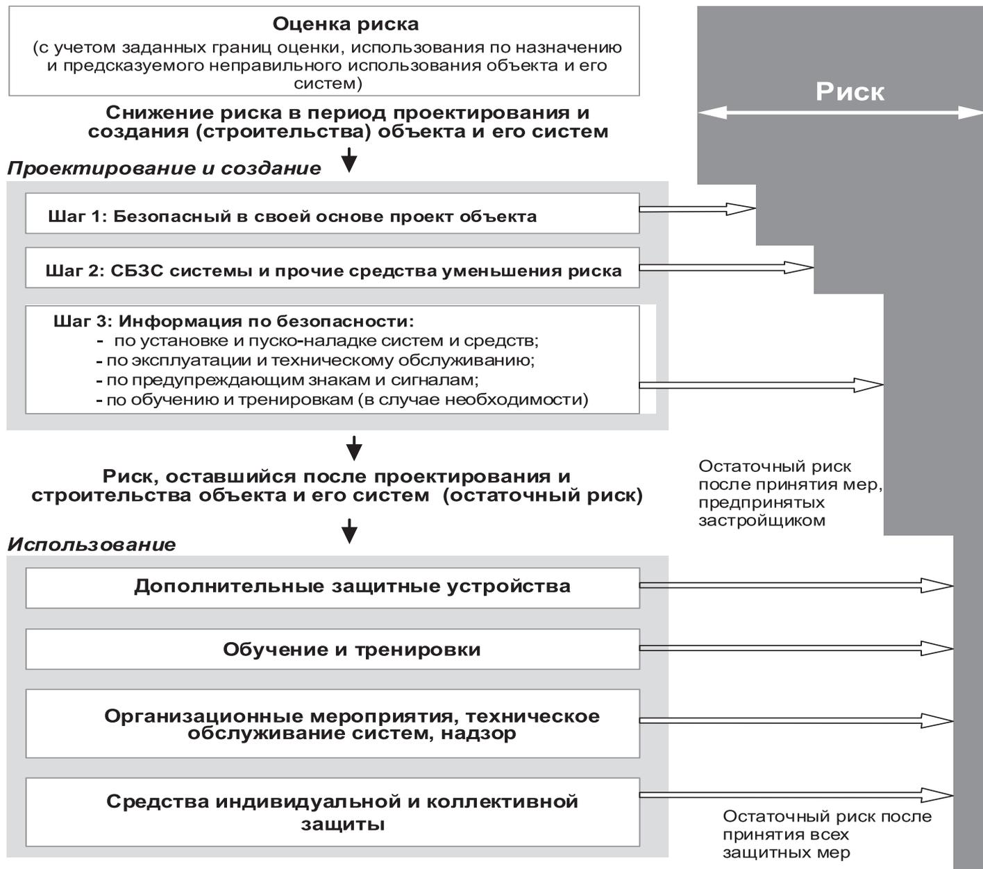
Рис. 3. Уменьшение риска с помощью комбинации мер на этапах проектирования, строительства и эксплуатации объектов
