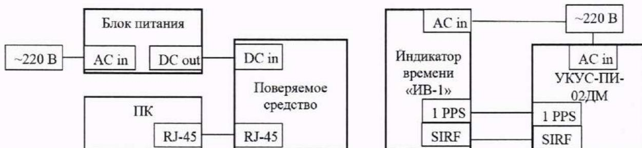
Рисунок 1 – Схема проведения измерений
